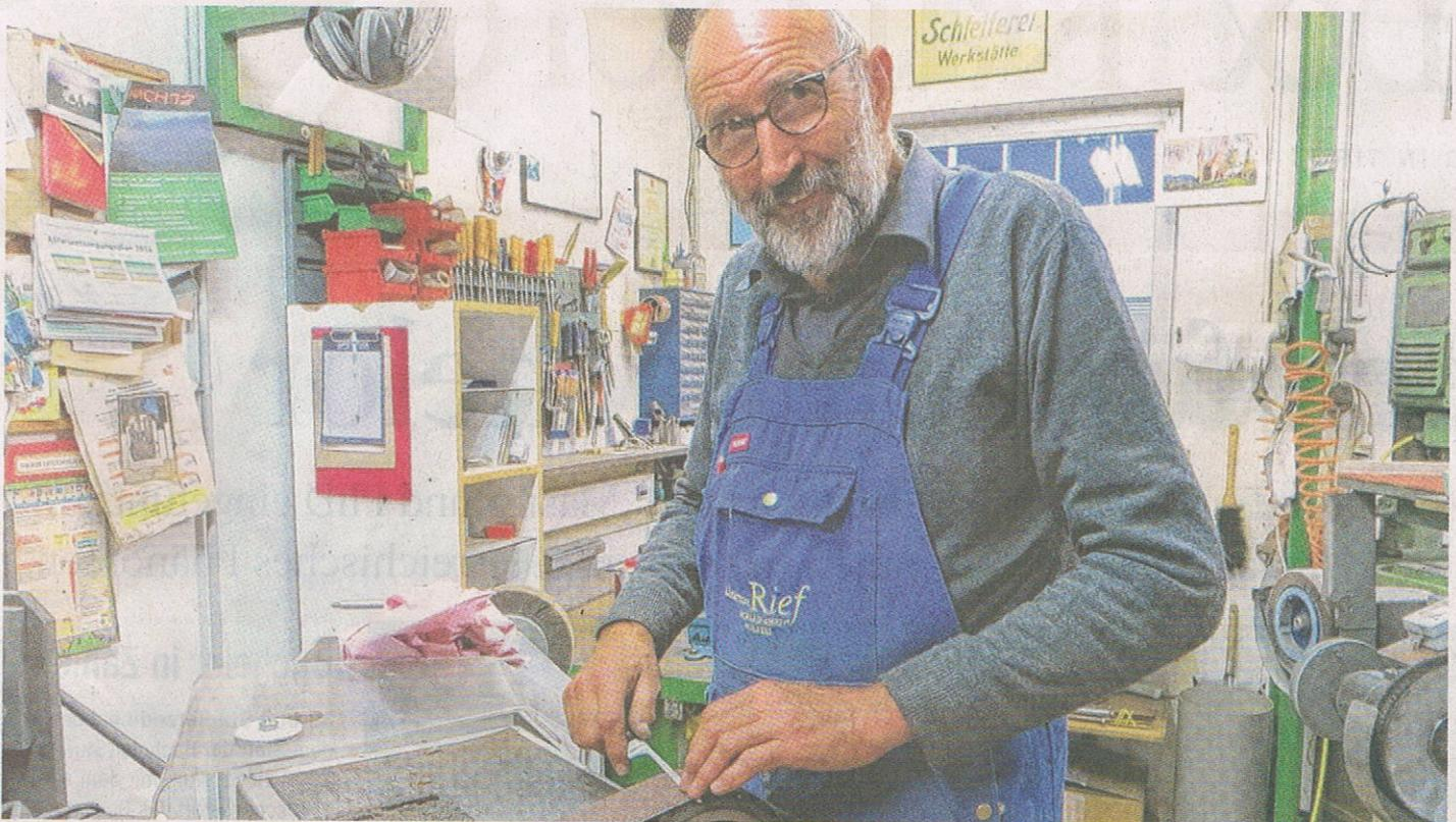
Messerschmied Helmut Rief hat sich auf das Schleifen von Messern spezialisiert. An der Bandmaschine gibt er der Klinge den Vorschliff.
